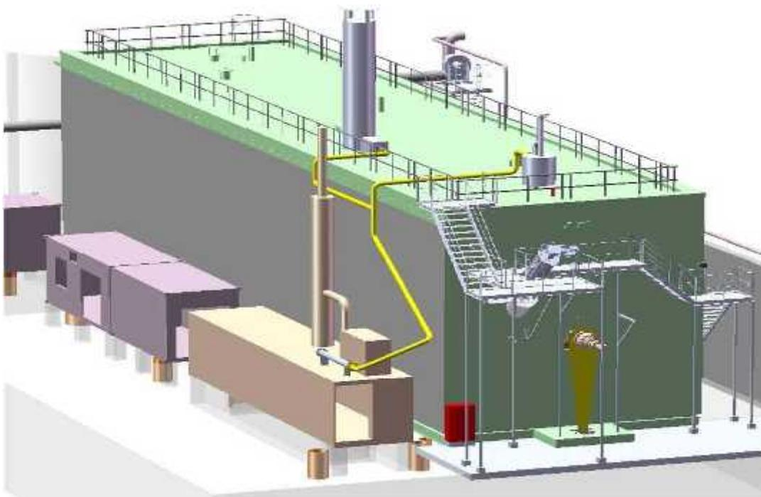
La biomassa inserita rimane all'interno del digestore per un periodo di ritenzione medio di ca. 20 giorni, durante i quali subisce i diversi processi di degradazione ad una temperatura mantenuta pressoché costante attorno ai 55° C per garantire le condizioni termofile, necessarie per l'igienizzazione del prodotto finale.
