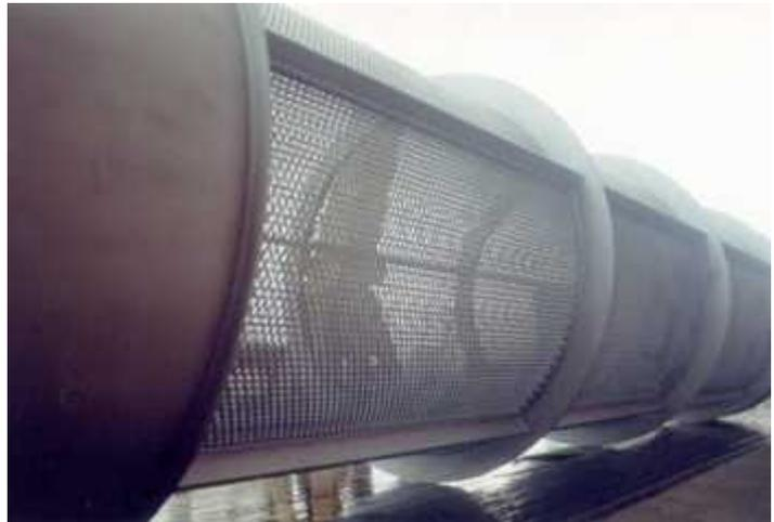
Il materiale che rimane all'interno del rullo (o sopra le rotelle) costituisce il cd. *sopravaglio*, di pezzatura più grossolana; mentre il materiale passante (più fine) va a costituire il *sottovaglio* o *sovvallo*. Quest'ultimo viene allontanato mediante un nastro trasportatore.
